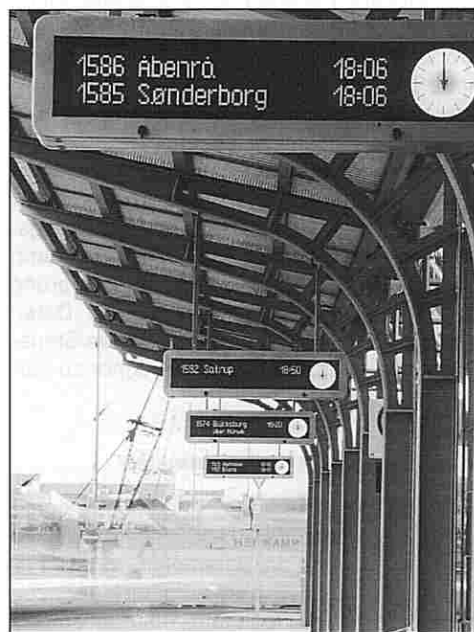
Abb. 2: Haltestellenanzeige – An jeder Haltestelle informiert eine Anzeige mit integrierter Funkuhr der Firma Infosystems Krueger den Fahrgast über Linie, Endhaltestelle und Abfahrtszeit. Die vollgrafikfähige Auflösung der Anzeigenfläche mit 24 x 144 Pixel erlaubt eine Vielzahl von Möglichkeiten bei der Wahl der anzuzeigenden Information: Sie kann 1-, 2- oder 3-zeilig erfolgen und neben Unterlängen auch Sonderzeichen und dänische Buchstaben anzeigen
